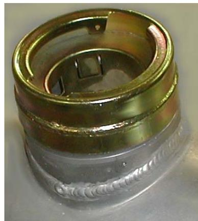
**Dispositivo per impedire il furto del carburante**
