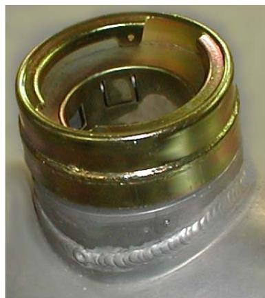
**Dispositivo per impedire il furto del carburante**
